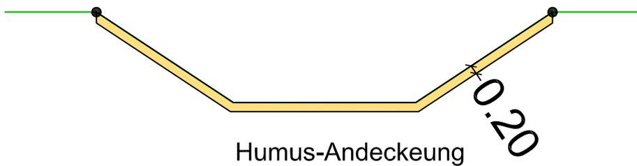
$$\text{Humus auf} = (\text{DGM}_{\text{Mulde-Neu}}) - (\text{DGM}_{\text{Mulde-Neu}} - 0,20)$$
