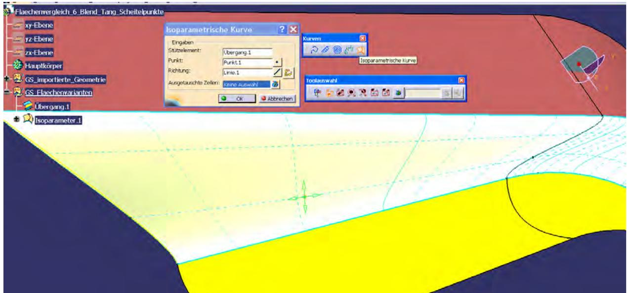
Bild 1: Isoparametrische erzeugen (Aufbereitung eingblendet)
