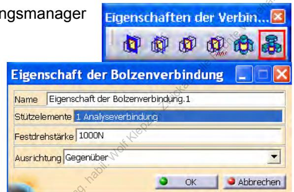
Bild 41: Schraubverbindung mit Vorspannung
