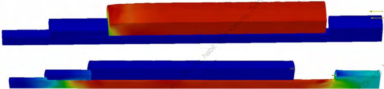
Bild 45: Von Mises-Spannung bei  $F_z$  -10000 N auf Hülsenstirnfläche oben, bei  $F_z$  3000 N auf Schraubenkopfstirnfläche unten
