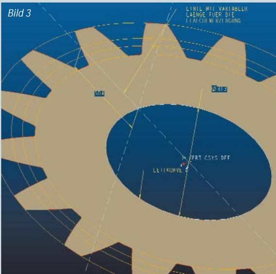
Hier ist die Leitkurve irgendeine Kreiskurve coaxial zu dem Mittelpunkt, z.B. FUSSKREIS oder Grundkreisdurchmesser. Die Ebene für die Normalrichtung ist die Ebene, in der die Fläche liegt. Damit die Fläche diese Gestalt (Bild 3) annimmt, sollten folgende Skizzierbeziehungen definiert werden:
