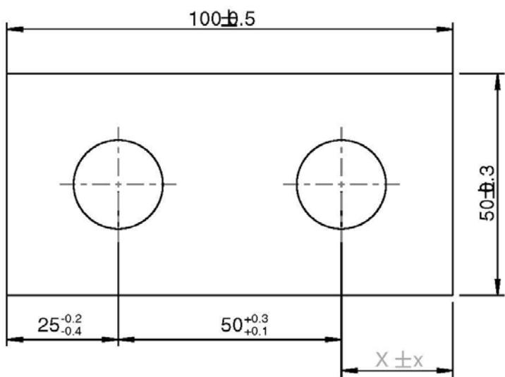
$$X \pm x = 100 \pm 0,5 - 25 \begin{array}{l} -0,2 \\ -0,4 \end{array} - 50 \begin{array}{l} +0,3 \\ +0,1 \end{array} = 25 \begin{array}{l} +0,8 \\ -0,6 \end{array}$$
