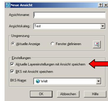
Im Manager für die benannten Ansichten können die zugeordneten Layereinstellungen (hier *Layer-Info* genannt) aktualisiert bzw. gelöscht werden. Auch die Definition der Ansicht kann über *Umgrenzung bearbeiten* angepasst werden. Hierzu wird die derzeitige Ansicht aufgezoomt und der umgrenzende Bereich mit einer Art „Grauschleier“ überdeckt. Durch picken zweier Punkte kann dann die neue Ansicht definiert werden.
