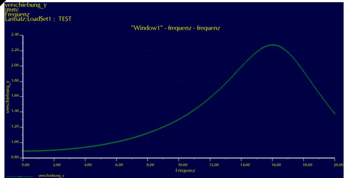
Die dyn. Frequenzanalyse wurde 2mal durchgeführt, einmal für den gesamten Bereich 0-2000Hz und für die ROI von 0-20Hz.
