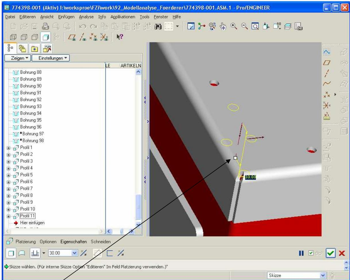
Baugruppen-Materialschnitt wird nach der Regenerierung nicht angezeigt. Das KE ist aber im Modellbaum vorhanden.
