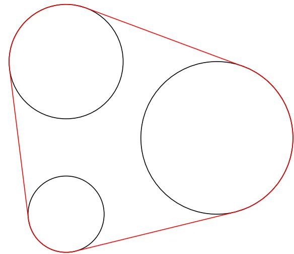
**Die nun entstandene rote geschlossene Polylinie mit dem Befehl "Versatz" nach aussen versetzen.**
