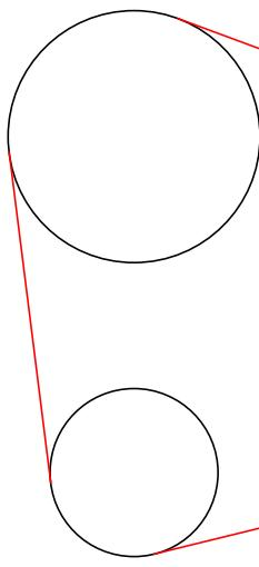
**Die roten Linien mit dem Befehl "2D Abrundung" geschlossene Polylinie zusammenführen. Die Abrundung der Linien ist der Radius der anliegenden Kreise.**
