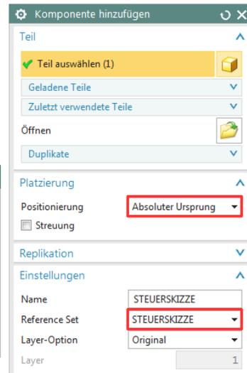
Nun erzeugen wir den Blechwinkel, hierfür muss zuerst wieder ein neuer Part erzeugt und anschließend zur Baugruppe hinzugefügt werden.
