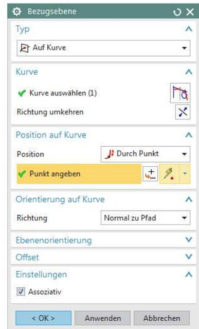
Nun erzeugen Sie eine *Bezugsebene (Datum Plane)* auf dem *Spline*, so dass die Neigung des *Splines* an der *Bezugsebene* ausgerichtet ist. Am Besten mit *Typ Auf Kurve (On Curve)*.
