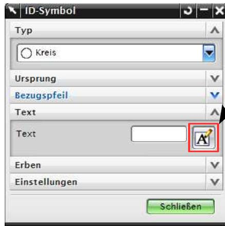
Auf der Zeichnungsseite wird die Positionsnummer mit einem *ID-Symbol* erstellt. Um jetzt die erstellten Attribute zu übernehmen muss mit der Funktion „Text“ gearbeitet werden.
