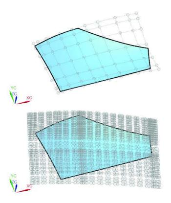
Was man bei beiden Funktionen erkennen kann ist, dass zur Berechnung der Fläche zunächst auf ein ungetrimmtes U-V-Gitter zurückgegriffen wird.
