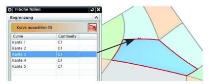
Nachteil der neuen Funktion gegenüber *Oberfläche mit n Seiten*: Es muss mindestens eine Kante angegeben werden. Ein Konturzug, der nur aus Kurven besteht, kann mit Hilfe von *Fill Surface* also nicht gefüllt werden.
