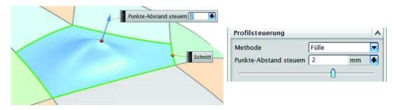
Den Punkt, in welchem des Offset angreift, kann man im Grafikfenster mit dem *Füllesteuerungs-Handle (Fullness Control Handle)* auf der Fläche verschieben.
