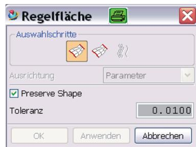
Die Funktion lässt sich zwei „Strings“ zeigen und verbindet diese Kurvenzüge mit einer Fläche. Immer wenn nach „Strings“ gefragt wird, können diese Kurvenzüge aus mehreren, zusammenhängenden Einzelkurven zusammengesetzt sein. In alten UNIGRAPHICS-Versionen (z.B. V2, V3, im Jahr 1985) gab es diese Funktion ebenfalls, man konnte aber nur zwei einzelne Kurven anwählen. Später stand dann in der
