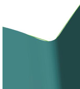
man diese defekten Flächen finden und lokalisieren können. Die Funktion dafür finden Sie unter: *Analyse > Geometrie überprüfen (Analysis > Examine Geometry)*. Die zwei Haken in dem teilweise abgebildeten Menü spüren die Selbstüberschneidungen auf. Wie man im Menü sieht, ist eine „Selbstschneidung“ (*Flächenüberschneidung, Self-intersection, Face-Face Intersections*) nicht nur bei
