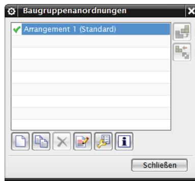
Um die verschiedenen Zustände in einer Zeichnung darstellen zu können, muss die Komponente bzw. Baugruppe mehrfach (unterschiedliche Situationen) in die Baugruppe geladen werden.
