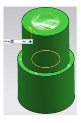
Um eine Zeichnung ohne Aufmass zu erstellen, wird einfach vom Ausgangsteil ("Welle mit Zapfen") eine *Master-Model-Zeichnung* abgeleitet.
