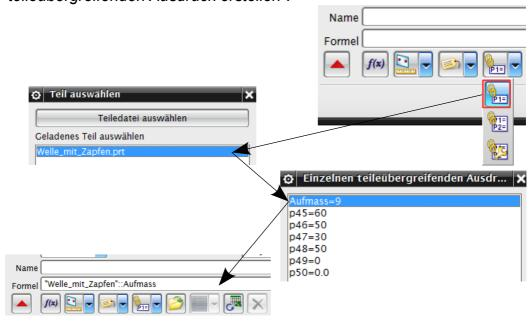
Der gelinkte *Ausdruck* muss in der Zeile "*Name"* eingetragen werden (Ausschneiden > Einfügen; <Strg>+X > <Strg>+V ). Für die *Formel* (*Formular*) wird der gewünschte Wert für das Aufmass angegeben.
