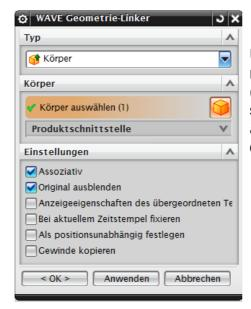
Über den WAVE Geometrie Linker wird nun der gesamte Körper ("Welle\_mit\_Zapfen") gelinkt. Haken setzen bei Assoziativ und Ursprung ausblenden, sonst ist die Geometrie doppelt zu sehen.
