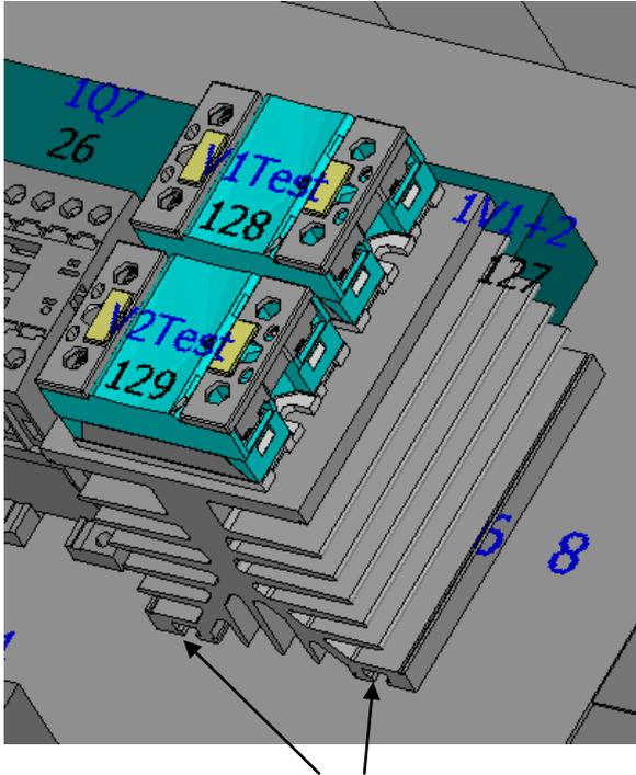
In diese Langlöcher wird eine Mutter geschoben und mit einer Schraube mit dem Halter verbunden
