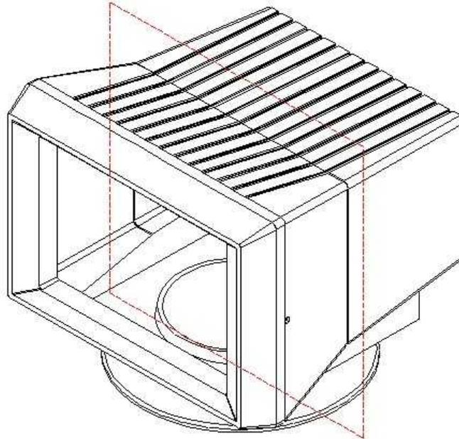
Nach dem Schneiden des Volumenkörpermodells sind die äußeren Radien verschwunden.
