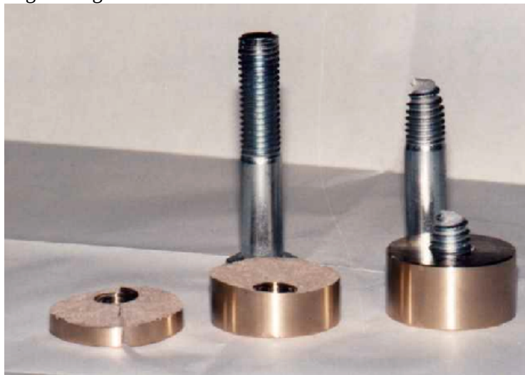
Bild 3: Kugelförmig geplatzte Mutter PAN 16 mit Bolzen M 20 x 110 aus 5.6 Links: Einschraubtiefe m = 17 mm, Zugkraft F = 135,6 kN, Mutter geplatzt Rechts: Einschraubtiefe m = 19 mm, Zugkraft F = 135,8 kN mit Bolzenbruch
