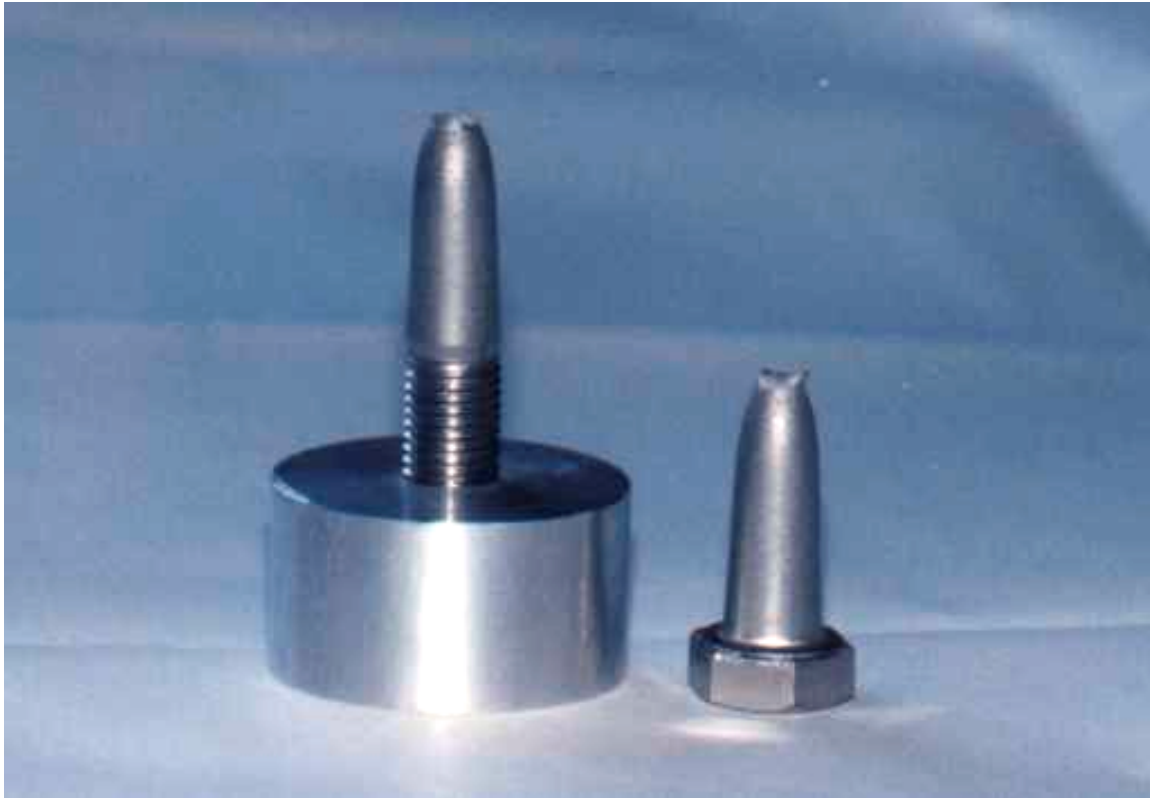
Bild 4: Austenitischer Bolzen A2-70, M 16 mit Alumutter aus 3.0615.71 (F 28)
