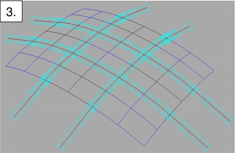
Flächen mit Zylindern verschneiden und entsprechende Flächen löschen
