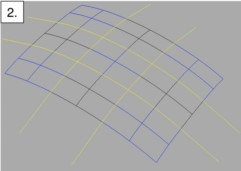
Mit dem Befehl „pipe“ um jede Kurve einen „Zylinder“ erstellen
