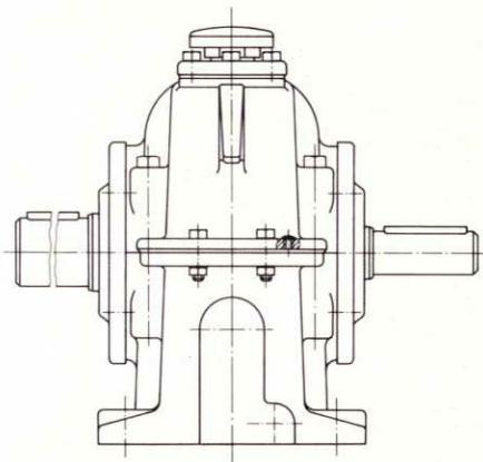
Stirnradgetriebe übertragen Leistungen von einem Antriebsmotor auf eine Arbeitsmaschine. Durch das Übersetzungsverhältnis  $i = z_2 : z_1$ , gegeben durch die Zähnezahlen, wird die Ausgangsdrehzahl  $n_2 = n_1 : i$  und das Ausgangsdrehmoment  $T_2 = T_1 \cdot i$  geändert.
