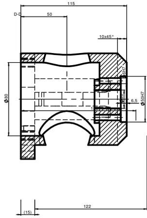
Bohrungen und Gewindebohrungen ±0.1
