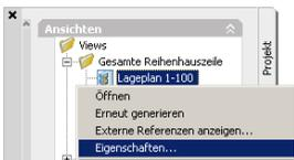
1. Wechseln Sie auf die Seite "Ansichten" des Projekt-Navigators. Sie werden feststellen, dass das Beispielprojekt Reihenhausanlage über verschiedene Ansichten verfügt, die in die Kategorien "Gesamte Reihenhausanlage", "Haus Mitte", "Haus Ost" und "Haus West" unterteilt sind. Öffnen Sie die Kategorien durch Klick auf das Plus-Symbol. Sie sehen nun die einzelnen Zeichnungen, die zu jeder Kategorie gehören.
