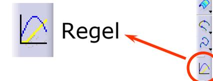
Mit Hilfe von Regeln oder Laws hat man die Möglichkeit, den Geometrieverlauf von Objekten in CATIA zu steuern. Häufig werden solche Regeln auf Freiformflächen bzw. -kurven angewendet. Am Beispiel des hier geöffneten Lüferrades soll gezeigt werden, wie eine Regel definiert und angewendet wird. Dabei soll der nichtlineare Verlauf des Verdrehwinkels in einer Regel abgebildet werden.
