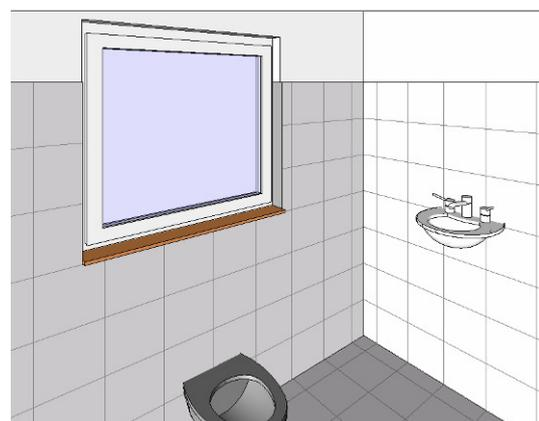
Wird dieses „Detail“ trotzdem als echtes 3D Bauteil benötigt, kann es relativ schnell als eigene Familie aus einer Extrusion heraus hergestellt werden (Modellieren – Erstellen...)
