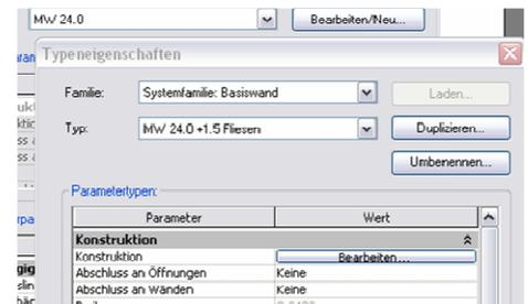
Zur vorhanden Schicht „Mauerwerk – Ziegel“ wird nun eine weitere hinzugefügt
