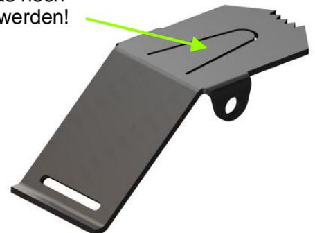
! Nach dem Einpassen wurden noch einige Winkel und Längen geringfügig geändert. Die Winkel sind noch über die Teilestruktur zu verändern. Dabei wird jedoch nur das Original- und nicht der gespiegelte Teil geändert.
