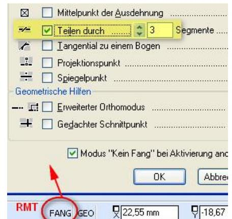
25. Nun mit dem Punktwerkzeug (gewählt: kreuzförmig) geplante Bohrpunkte markieren. Fang auf den Linien auf der Schräge.
