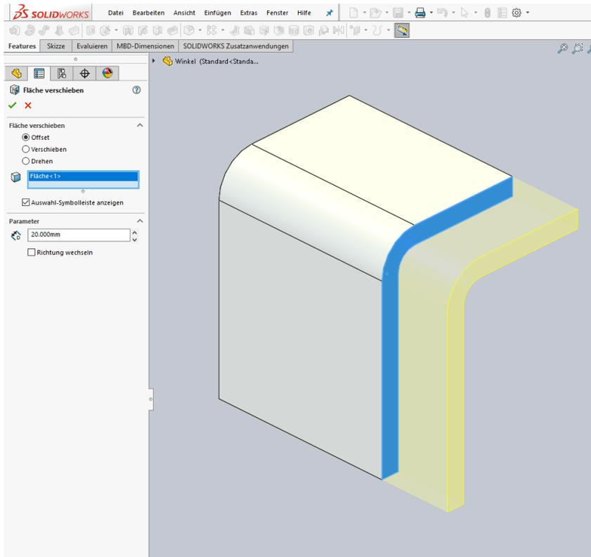
Die Profilfläche des „Blechwinkels“ kann im Gesamten mit „Fläche verschieben“ verschoben werden.
