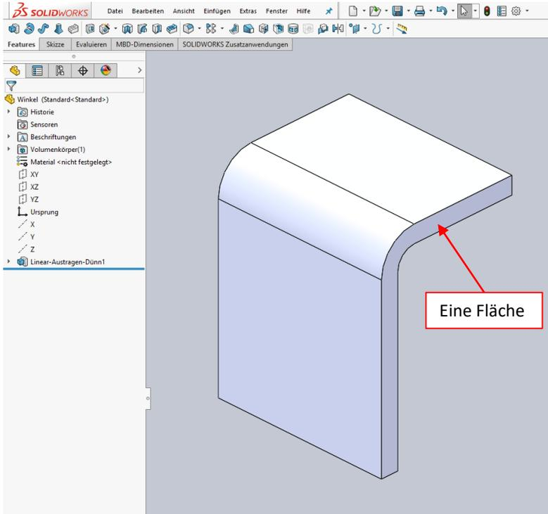
Beim Modellieren eines Blechwinkels entsteht eine Profilfläche aus mehreren fluchtenden Flächen.
