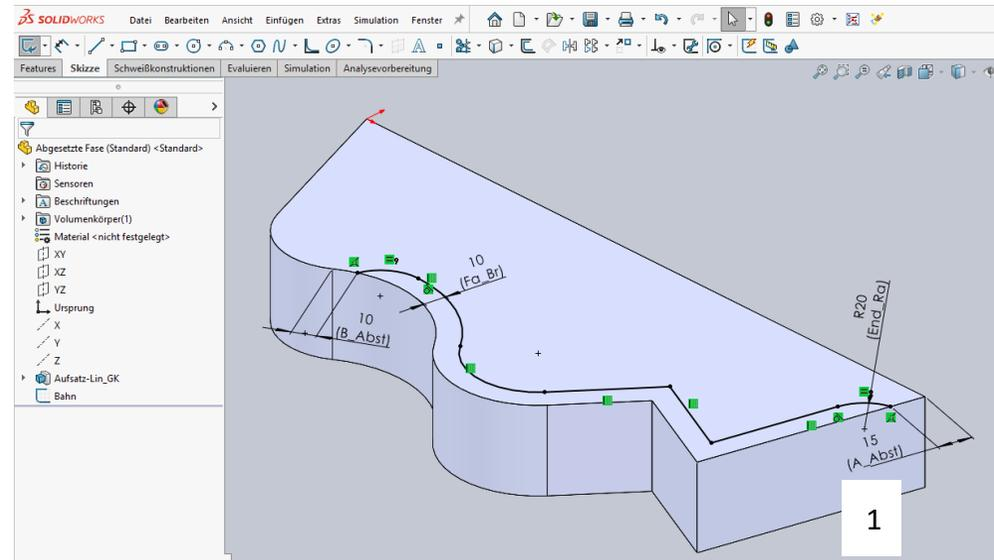
An Innenecken Skizzenverrundungen anbringen. Radius gleich Endradius beziehen.
