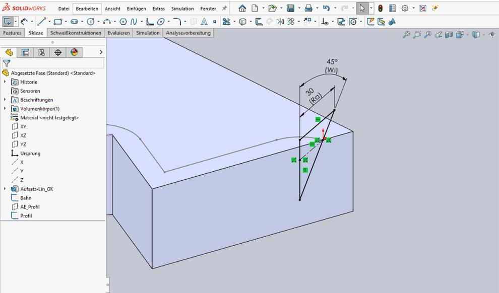
Aus Profil und Bahn eine Schnittausragung erzeugen.
