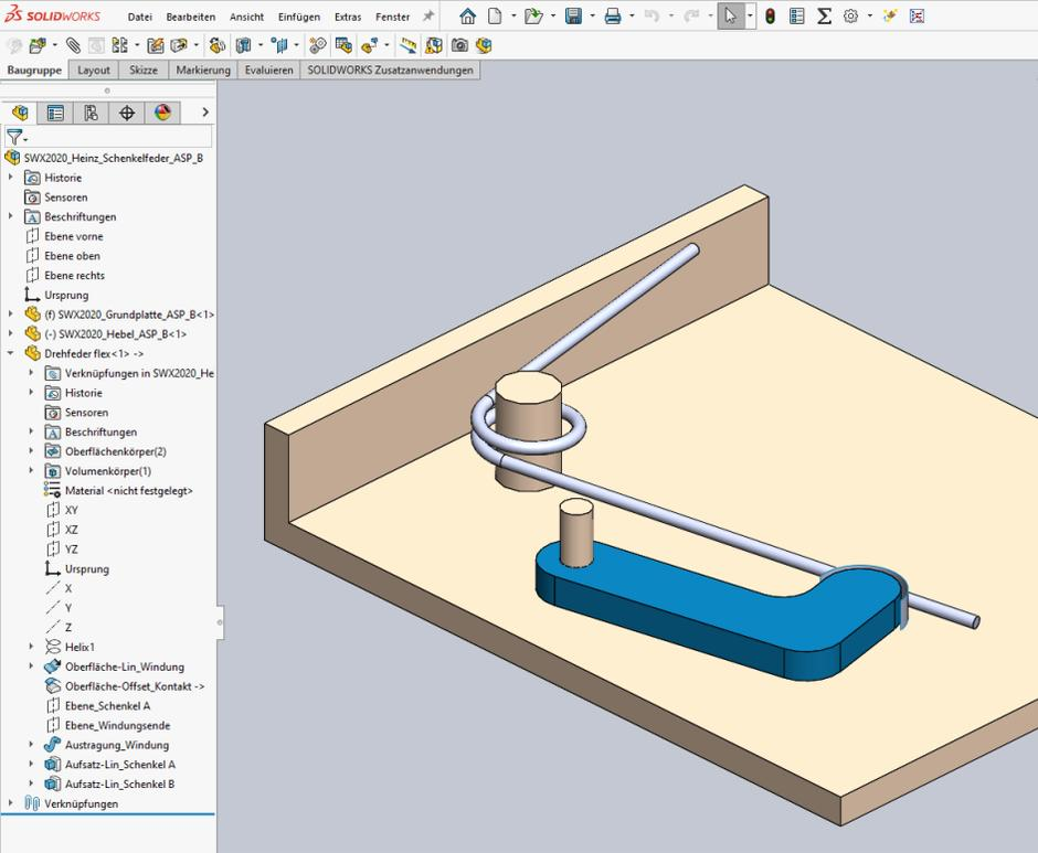
Beim einfügen der Drehfeder in eine weitere Baugruppe, die die Feder auf „Teil flexibel machen“ setzen und die externe Referenz neu zuordnen.
