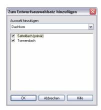
Mit "Optionen ändern" wählen wir nun die Option "Satteldach (primär)" zum Bearbeiten aus, konstruieren dort ein Satteldach und fixieren die Wände an diesem Dach.
