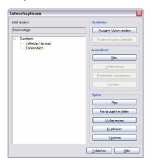
Jetzt steht in Revit der Button "Optionen ändern" zur Verfügung, der auch gleich angeklickt wird.
