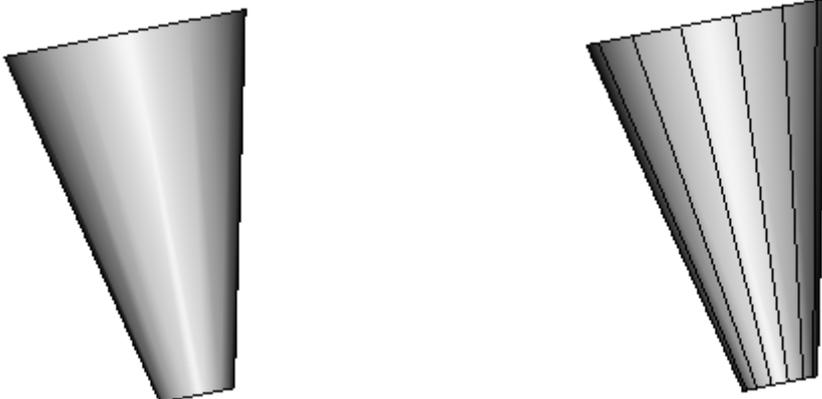
2. Dann gehst Du im Fenster "Fassette" auf Manipulieren und wählst dann "Entfalten" aus Du wirst aufgefordert "Netzelement Auswählen" nach dem anklicken des Elements musst Du nun einen Ablagepunkt bestimmen also auf der Ansicht/Zeichenfenster einen Mausklick absetzen und das Element wird nun Entfaltet abgelegt
