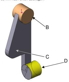
Jetzt kommen die Bohrungen. Man könnte sie mit dem Bohrungsassistenten bzw. als einfache Bohrungen erzeugen. Ich habe sie hier als linear ausgetragene Schnitte gemacht, da der Bohrungsassistent der Version 2001 schon zu weit zurückliegt und ich nicht mehr weiß, wie der aussieht.
