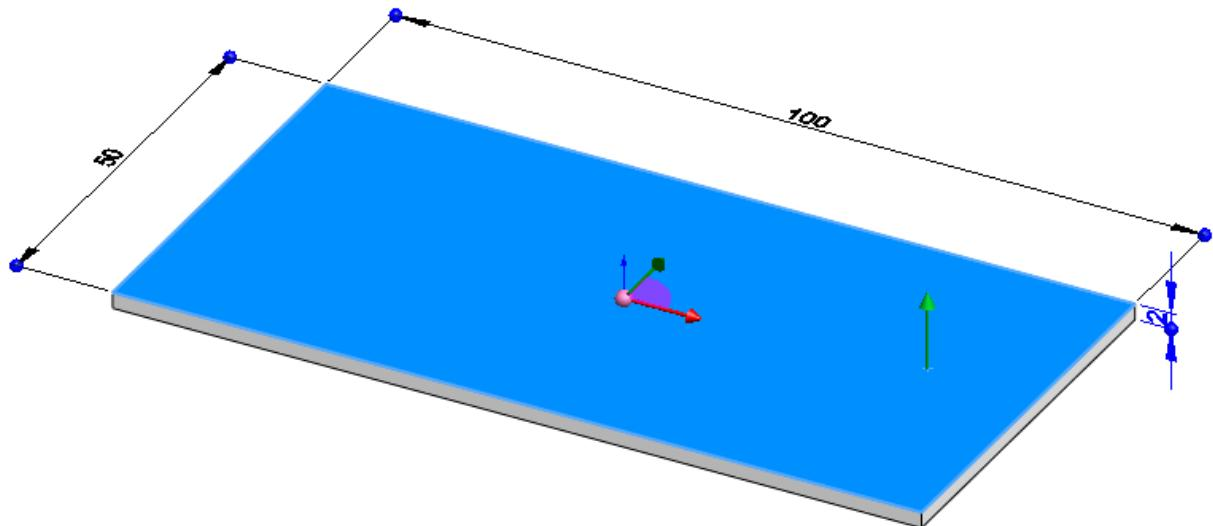
**2 Eigentliche Form auf dem Block erstellen (Die unteren Radien dürfen nicht kleiner sein als die Blechstärke, auf dem das Werkzeug Anwendung findet !)**
