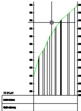
Die Höhen und Stationsbeschriftung ist Bestandteil des Bandes (aber bereits ab 2010 NEU).
