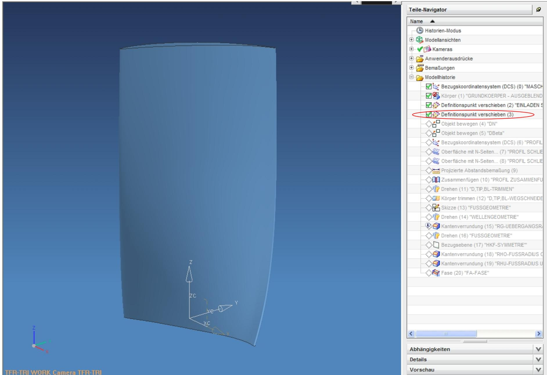
4. Formelement Zusammenfügen wurde als Aktuelles Formelement ausgewählt. Das Profil wurde Korrekt geschlossen und verschoben.
