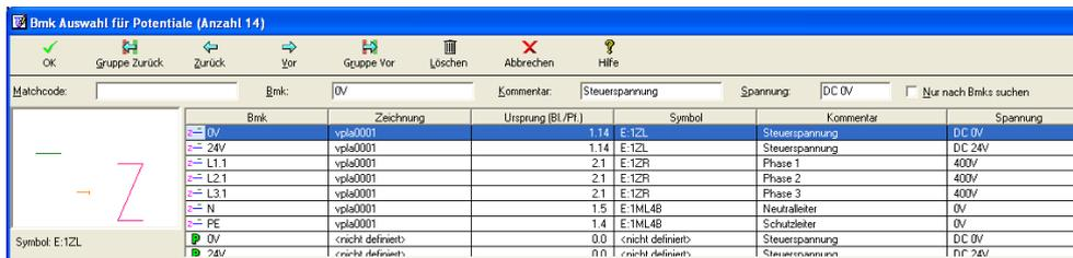
Abbildung 9.16: Beschriftung der Potentialabbruchstelle (0V)
