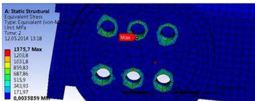
Am Ende der Bohrlöcher treten hohe Spannungen auf
