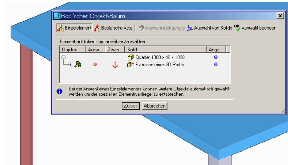
...nun besteht die Möglichkeit, trotz Zwangsbedingung das Profil an einem neuen Ort zu positionieren...
