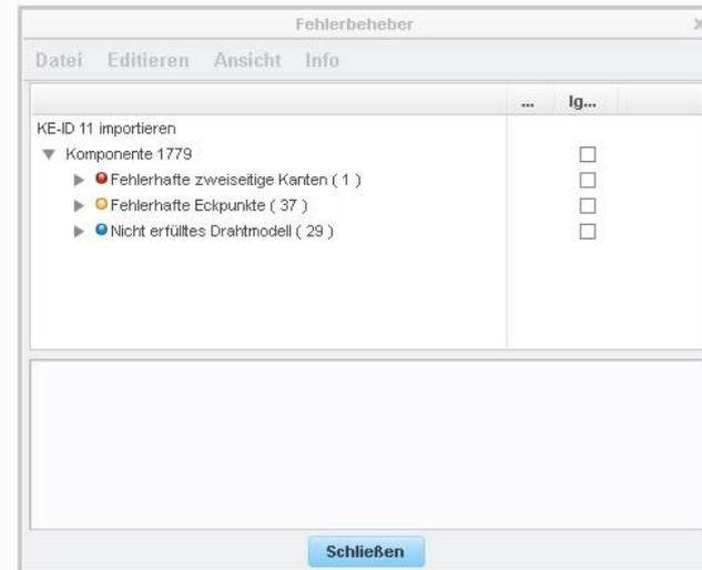
Nach dem Livetransfer in von Design X in Creo liegt ein Flächenmodell mit einer Reihe von Fehlern vor
