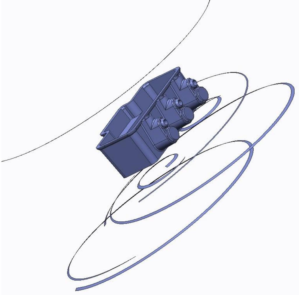
Nach einem Export des Bauteils in ein STEP File und anschließendem Import in Creo erhält man ebenfalls ein Flächenmodell mit Fehlern
