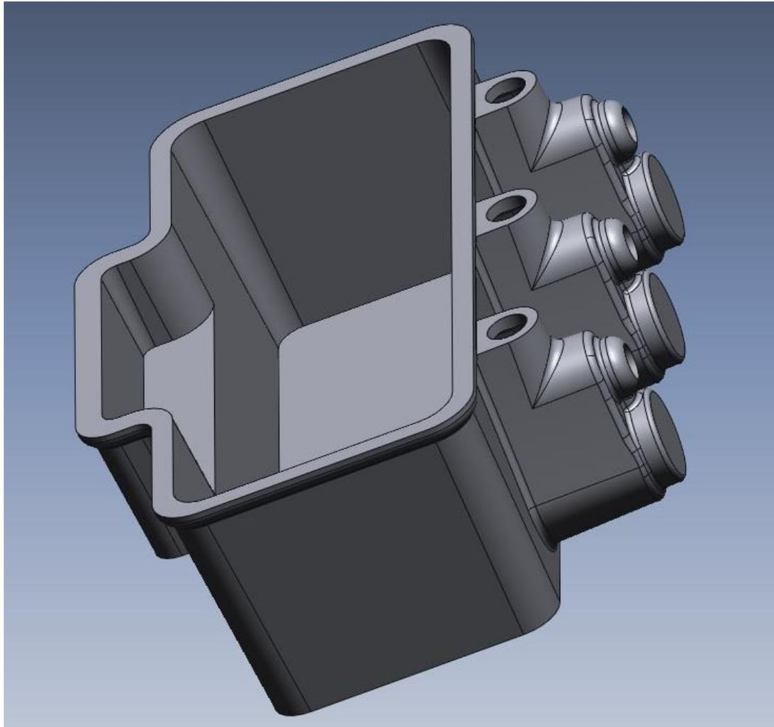
Erzeugtes 3D Volumenmodell basierend auf Scandaten mit Geomagic Design X
