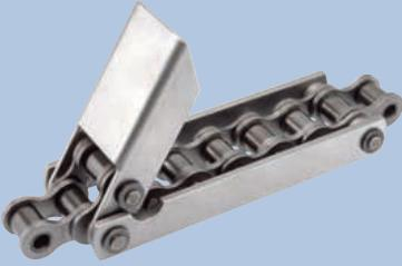
Der WIPPERMANN-Kipphebel steht während des Transportes im rechten Winkel zur Kette. Bei der Umlenkung, taucht er unter dem zu fördernden Gut durch, ohne dieses zu beschädigen.
