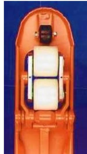
Die für die Anwendung idealen Werkstoffe PA 6 G und PA 12 G sowie das Mischpolyamid PA 6/12 G überzeugen darüber hinaus durch eine werkstofftypische Elastizität. Diese gewährleistet, dass unter statischer Last entstehende Abplattungen zuverlässig und schnell zurückgebildet werden. So kann schon kurz nach Wiederaanlauf ein schwingungsfreier Betrieb sichergestellt werden.
