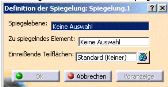
2. Die zu spiegelnde Komponente auswählen. In diesem Beispiel wird 'Cut Out.1' ('Ausschnitt') ausgewählt.
