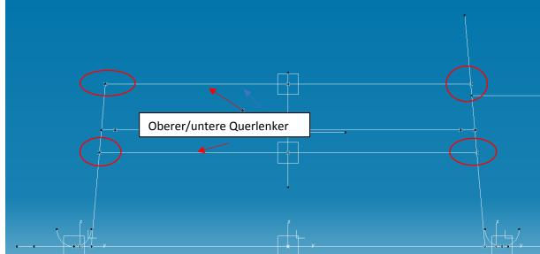
Das Skelet bewegt sich wie gewollt, die Geometrie ist direkt aus Publikation aus dem Fahrzeugskelet übernommen. Die Punkte stellen die Drehpunkte der Traggelenke dar. Die Querlenker sind s modelliert, dass sie über die Punkte für die Gelenke aus dem Fahrzeugskelet gesteuert werden. Der Abstand zwischen Punkt und Querlenker entspricht genau der Größe des Traggelenkes
