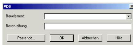
Unter **Passende...** erhalten Sie eine Liste der in ecscad enthaltenen Schütze. Wir wählen jetzt einen Leistungsschütz mit 1 Schließer als Hilfskontakt aus
