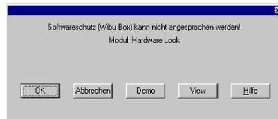
Klicken Sie den Button **Demo** an, um mit dem System als Demoversion zu arbeiten. Stört Sie diese Abfrage, können Sie in der Datei `ecscad\work\PASSWD.TXT`, die z.B. mit NOTEPAD editiert werden kann, in der ersten Zeile das Wort **[Passwords]** durch **DEMO** ersetzen. Dadurch erscheint die Abfrage nicht mehr und das System geht nach dem Start automatisch in den Demo-Modus.
