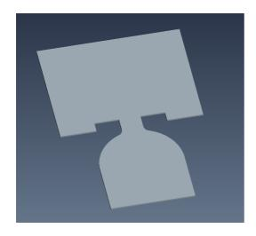
Erstellen einer Biegung vom Typ Rolle mit Übergang! Vorsicht darauf achten, welche Linie zuerst gezeichnet wird, da sonst die falsche Seite gebogen wird!
