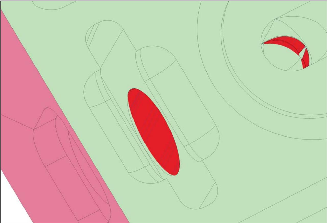
Rot dargestellte Flächen haben Abschnitte mit Hinterschneidungen. Blaue Linien zeigen (ggf.) Bereiche mit Hinterschneidungen an. Wir können diese Hinterschneidungen mit dem derzeitigen Protomold-Verfahren nicht herstellen.
