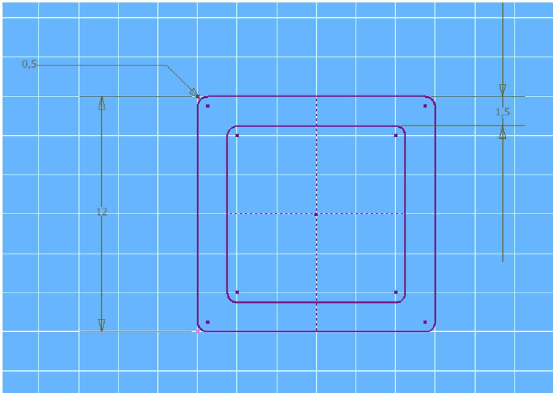
3. Beenden Sie die Skizze und Extrudieren Sie das Profil 10mm (Extrusionstiefe ist frei wählbar)
