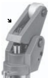
**Integrierter Stoßdämpfer:** Absorbiert die Aufprallenergie und bremst den Werkstückträger sanft und geräuscharm ab. Anpassung der Aufprallenergie durch Regulierschraube im Kipphebel.
